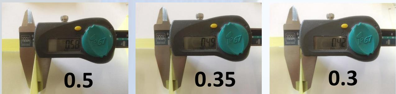
Wir erreichen bei einem Extrusionsmultiplikator von 0.3 eine Layerbreite von 0.42mm. Somit drucken wir die Teile mit einem reduzierten Fluss von 70%.
